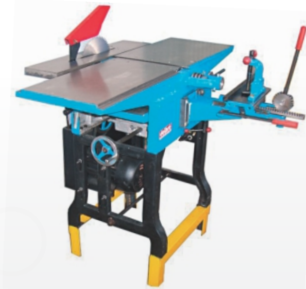
Garlopa de 300 mm. Con 3 cuchillas, mesa de 1200 x 360 mm, con regulación de espesor.
